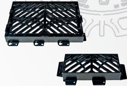
Ensemble grille + cadre D400. Largeur 504 mm, longueur 704 mm. Articulée avec ouverture jusqu'à 110° avec blocage de sécurité pour éviter la fermeture accidentelle. La grille reste encastrée pour éviter les mouvements et le bruit lors de la circulation. Destinée aux chaussées sujettes aux grandes averses, grande capacité d'absorption. Conception des barreaux avec pente inversée pour faciliter l'absorption. Ouverture facile avec les outils communs de chantier.
